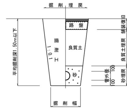
\* 舗装、土工構成は、本管土工標準図に準ずる。
