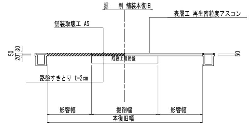
舗装取壊は、原則としてカッターにより施工すること。
