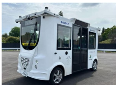
図 VISON 内を走行する自動運転バス 出典:中部運輸局提供
